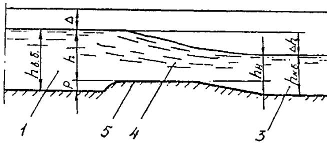
а - водослив с тонкой стенкой ; б - лоток с боковым сжатием ; в - лоток или водослив с широким порогом; 1 - подводящий участок канала (верхний бьеф); 2 - стенка водослива ; 3 - отводящий участок канала (нижний бьеф); 4 - горловина лотка; 5 - порог
