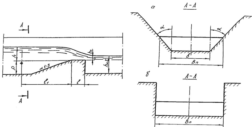
а - в каналах трапецидального поперечного сечения
