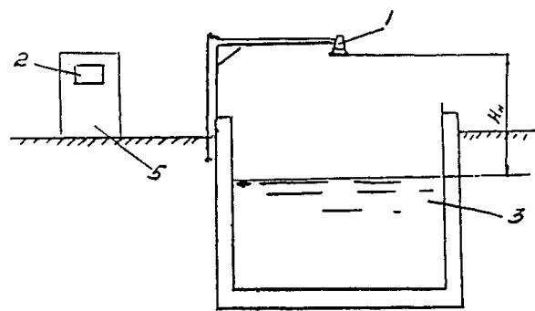
1 - акустический преобразователь, 2 - передающий преобразователь, 3 - канал, 4 - уровнемерный колодец, 5 - приборный шкаф.
