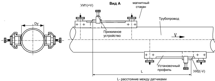
Рис.6. Установка датчиков на трубопроводы  $Dy > 1500$
