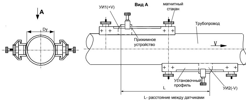
Рис. 5 Установка датчиков на трубопроводы  $500 < Dy < 1500$
