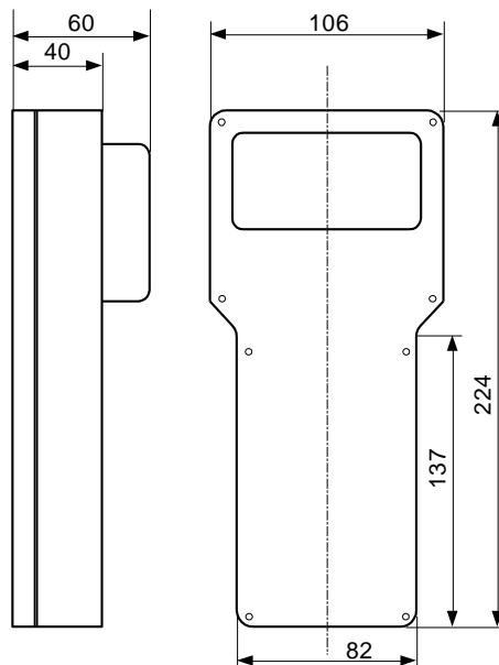
Рис.1. Электронный блок БЭ-2. Габаритный чертеж
