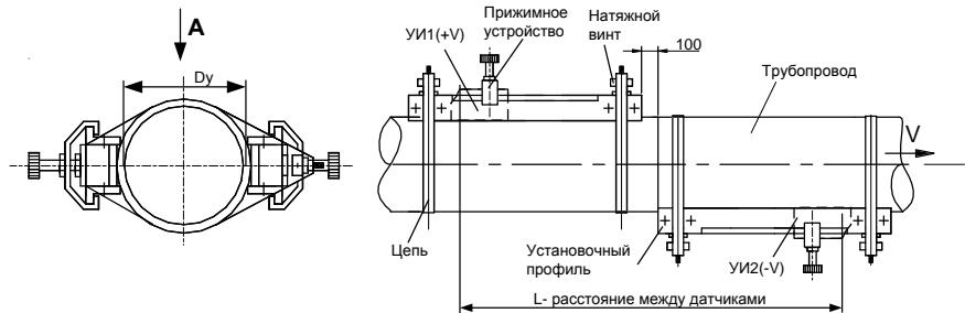
**Вариант крепления с помощью зажима**
