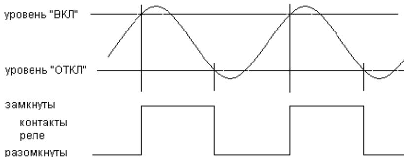
В режиме 2 контакты реле замыкаются при уровне меньше значения "ВКЛ" и размыкаются при уровне больше значения "ОТКЛ".
