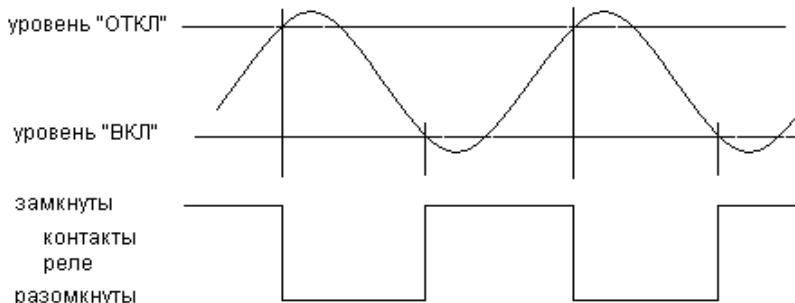
Режим работы выбирается автоматически при установке уровней "ВКЛ" и "ОТКЛ": если уровень "ВКЛ" больше уровня "ОТКЛ", то выбран режим 1, если уровень "ВКЛ" меньше уровня "ОТКЛ", то выбран режим 2. Контакты реле уста-
