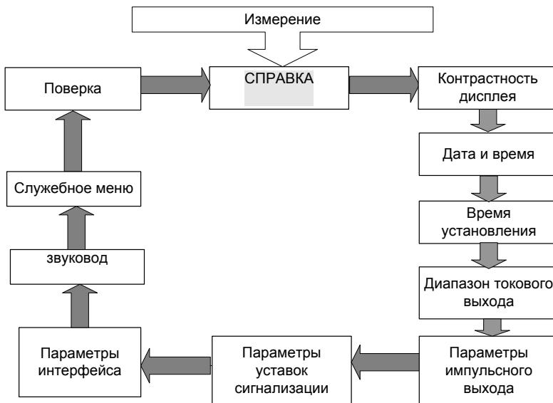
В режиме "СПРАВКА" можно просмотреть расходную характеристику прибора (таблица) и идентификационные данные программного обеспечения.
